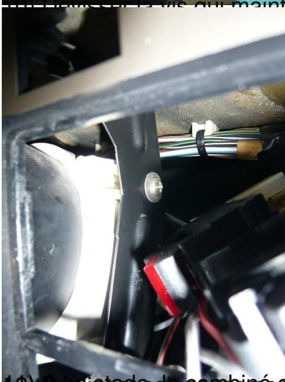
12) Une fois que le combiné d'instruments est démonté, aller à l'arrière des connexions
