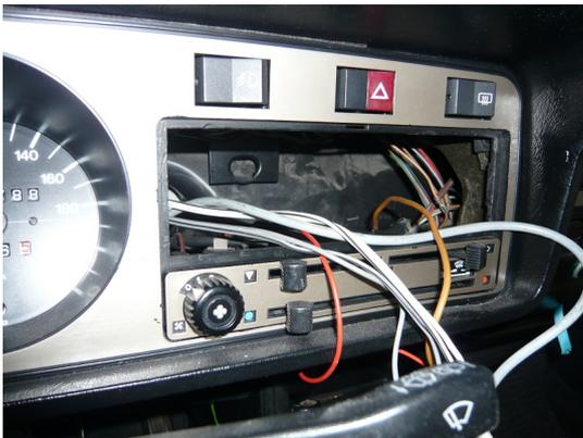
3) Retirer les commandes de chauffage, la molette et le « potentiomètre à plots » de soufflerie, et le cadre champage
