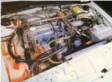
Le turbo délivre jusqu'à 1,03 bars de poussée sur des pistons forgés de chez Carillo, un arbre à cames
